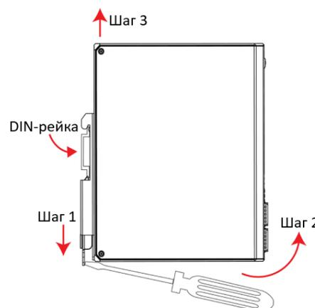
**ПРИМЕЧАНИЕ** Крепление на DIN-рейку теперь оснащено быстросъемным механизмом, позволяющим пользователям легко снять коммутатор с DIN-рейки.
