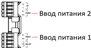
**ШАГ 1:** Вставьте положительный/отрицательный контакты источника постоянного напряжения или контакты фаза/ноль источника переменного напряжения в клеммы терминального блока V+/V- или L/N соответственно.
