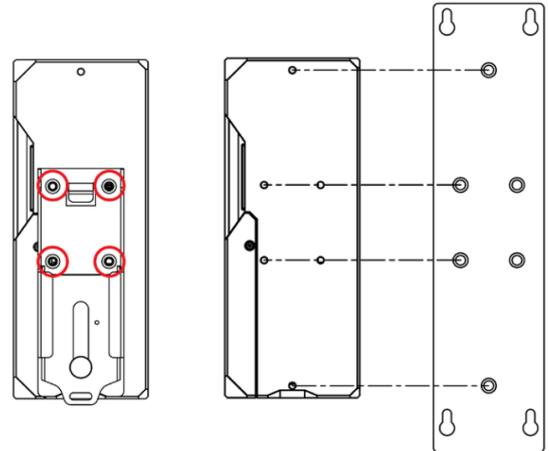
**ПРИМЕЧАНИЕ** Прежде чем затянуть шурупы, убедитесь, что они подходят по размеру, только после этого вставьте шуруп в отверстие в виде замочной скважины на комплекте для установки на стену.
